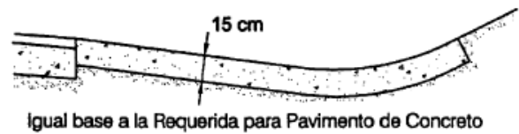
CUNETA DE CONCRETO
